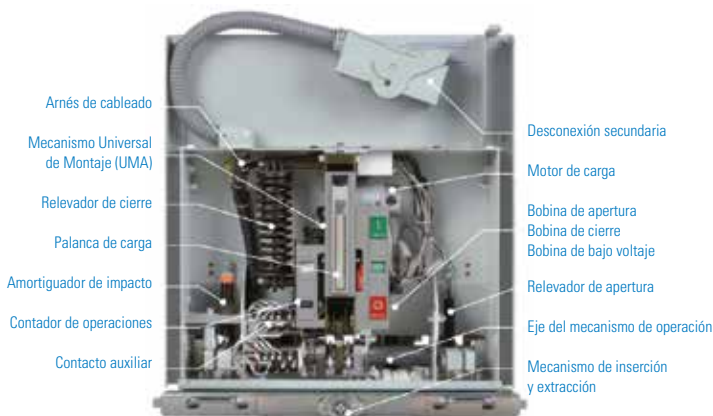
Interruptor W-VACi sin la cubierta frontal
